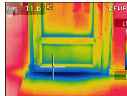
Infiltrations d'air au niveau du seuil de porte
