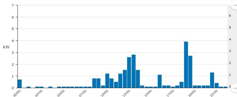
La courbe de charge est exprimée en kilowatt. Elle peut permettre de voir si l'abonnement choisi est bien dimensionné. Dans le cas ci-dessus, l'occupant a souscrit un contrat de 6 kW, soit 6 000 W, c'est-à-dire la puissance maximum qu'il peut solliciter. En fin de journée, il y a un pic de puissance dépassant les 3 kW. Nous pouvons en conclure que l'abonnement est bien dimensionné, mais il pourrait être proposé de mieux répartir les usages ou de favoriser une utilisation des heures creuses.
