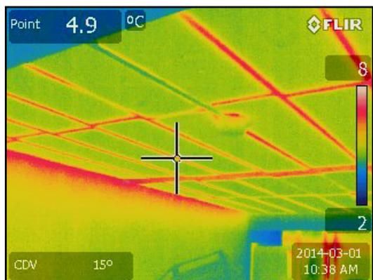
Pont thermique de l'ossature d'un plancher bas
