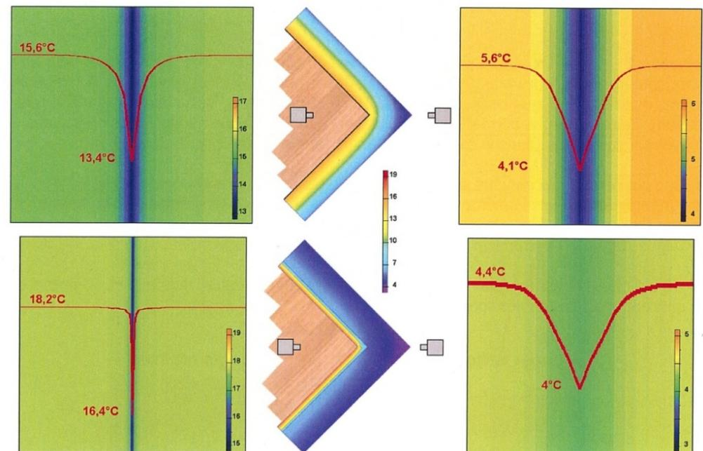
Figure 9 - (ci-dessus) Thermogramme simulé d'un angle saillant
