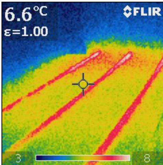
Vérification des réseaux d'un plancher chauffant
