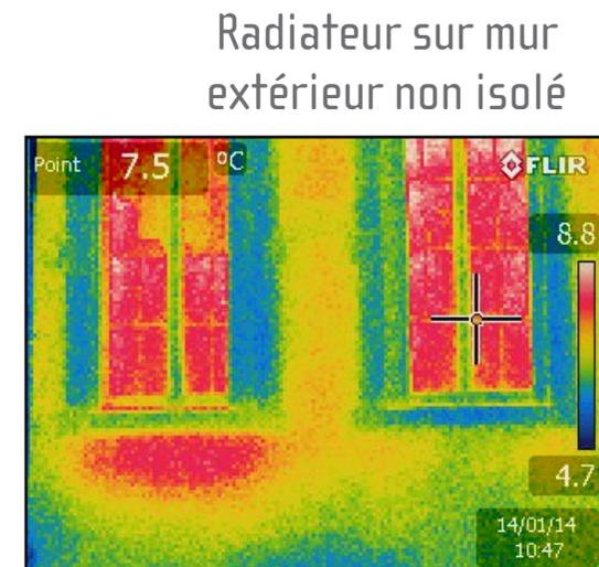
Radiateur sur mur extérieur non isolé
