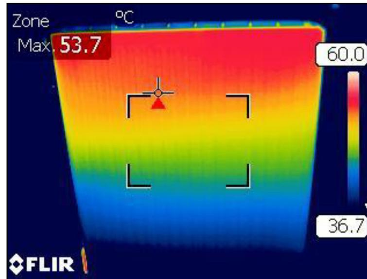
Mauvaise répartition de la chaleur dans le radiateur et stratification de la température du radiateur emboué
