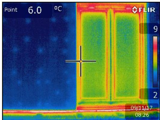
Pont thermique de plancher bas
