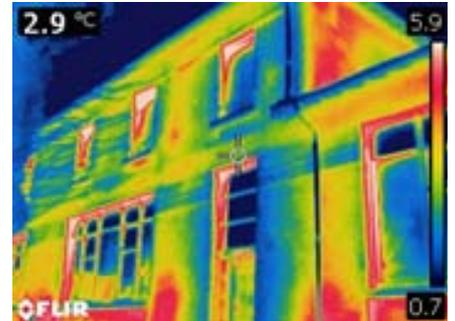
En période hivernale, de nombreuses visites à l'aide d'une caméra thermique ont été réalisées. La caméra thermique est l'outil privilégié des prédiagnostics énergétiques. Elle rend visible les ponts thermiques, les défauts d'étanchéité, problèmes de rayonnement des émetteurs...
